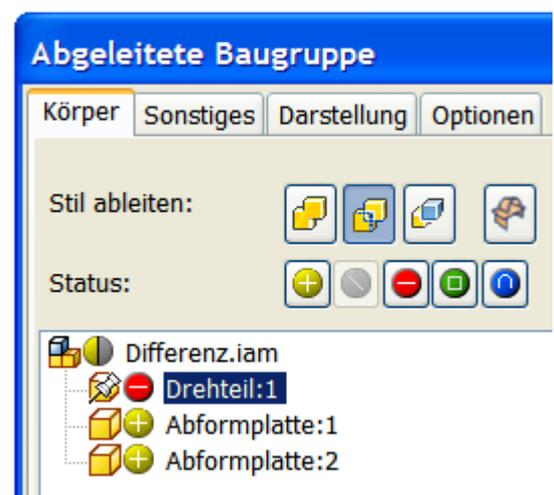
Wählen Sie im Kontextmenü der Abformplatte.ipt:1 im Browser „Elemente unterdrücken“, um die obere Hälfte der Abformvorrichtung unsichtbar zu schalten.
